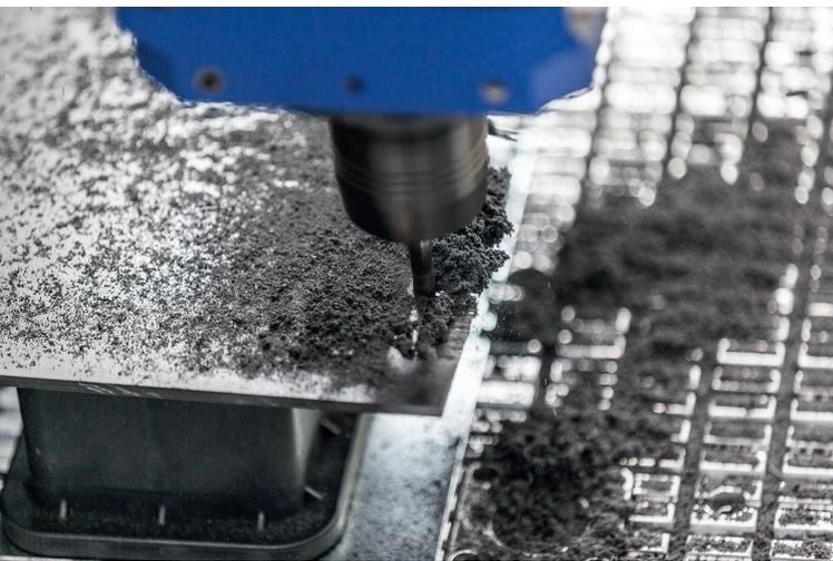
3 Die feinen CFK-Stäube, die beim Fräsen anfallen, sind gesundheitsschädigend und wirken abrasiv. Düsen blasen sie deshalb in eine Absauganlage (© Fraunhofer IPA)
