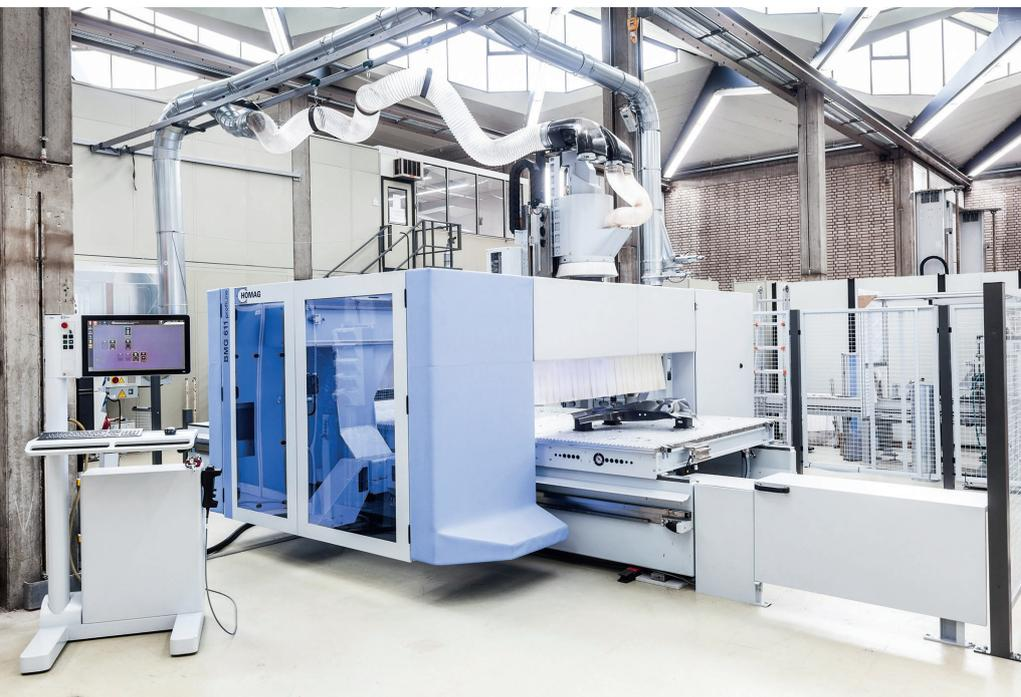
**1** Forscher vom Fraunhofer IPA haben zusammen mit Partnern aus der Industrie eine Maschine entwickelt, die Leichtbauteile nicht nur präzise fräst, sondern auch automatisiert abmisst und versiegelt (© Fraunhofer IPA)
